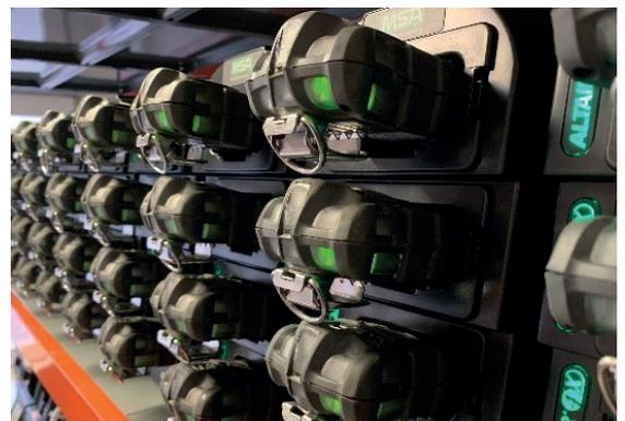
Leistungsstarke Ladegeräte ermöglichen kurze Akku-Ladezeiten: Mit weniger als 4 Stunden Ladezeit ermöglichen die langlebigen Li-Polymer Akkus eine Einsatzdauer von bis zu 24 Stunden. Die Ladung ist über Einzellader oder zusammensteckbare Mehrfachladegeräte möglich
