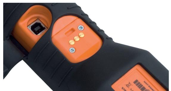
Die integrierte **USB 2.0-Schnittstelle** ermöglicht die direkte Übertragung von Daten auf Ihren PC. Einfach mittels handelsüblichem USB-Kabel
